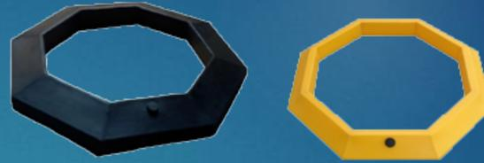
Base para Trafitambo modelo ABA fabricada en polietileno de media densidad 100% virgen y protección U.V, alta resistencia y durabilidad. En color amarillo y negro dimensiones: 69 x 9 cm. (diámetro por altura) la base puede ser llenada con arena por medio de su tapón, que facilita tanto el llenado como el vaciado, con forma apilable.
