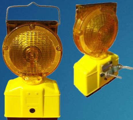
Lampara de destello solar con clip para el Trafitambo , sensor de luz para encendido, panel solar de silicón monocristalino, mica de poliestireno, base de polipropileno, asa metálica con recubrimiento de zinc, 4 leds de 5 mm de alta intensidad, batería de 1.2 v a 1500 mah.
