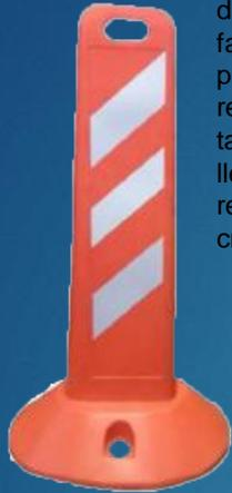
Barricada fabricada en polietileno virgen de media densidad con protección UV, fabricado en una sola pieza por el proceso de rotomoldeo, para mayor resistencia al impacto, cuenta con un tapón en la parte superior para su llenado. Opción de llevar bandas reflejantes, dimensiones: Base: 62 x 42 cm, altura: 124 cm, peso: 4 Kg.
