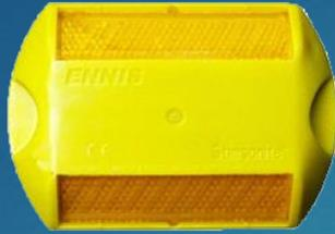
Violeta mod. C-80, a una cara o ambas, sin perno, cuerpo plástico de PVC, dimensiones de 11.6 cm de frente x 8.1 cm de largo x 1.70 cm de altura, reflejante prismáticos de metilmetacrilato, ángulo de la cara reflectiva de 35° de la base, área reflectiva de 16.8 cm<sup>2</sup>, área de contacto disponible de 100 cm<sup>2</sup> aprox., molde de acuerdo ASTM D788 grade 8, colores disponibles: blanco, amarillo y rojo.
