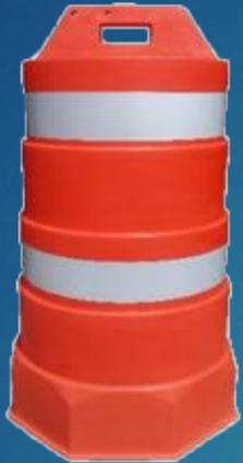
Trafitambo modelo ABA, fabricado en polietileno de alta densidad, de 4.2 kg, resistente a los rayos U.V., con la opción de llevar dos cintas reflejantes grado ingeniería color blanco de 9.5 cm. ancho, Dimensiones: base de 54 cm de diámetro diámetro superior de 39 cm altura de 104 cm.
