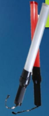
Bastón luminoso de 6 funciones recargable, el asa esta fabricada de ABS y el tubo de PVC, distancia de visibilidad mayor a 200 m, frecuencia de flasheo de 3.3 hz , funciones: flasheo rojo, flasheo verde, flasheo intermitente verde-rojo, lámpara en la punta, apuntador laser y silbato, utiliza 3 baterías tipo c recargables, dimensiones: longitud 54 cm, y diámetro 4 cm.
