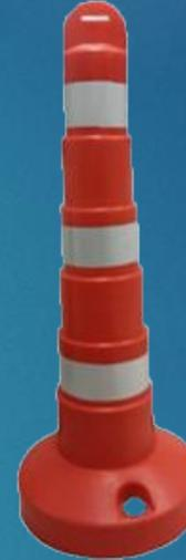
Trafivial fabricado en polietileno de media densidad color naranja, 100% virgen y con aditivo UV, fabricado en una sola pieza, Uniformidad en el espesor de las paredes de la pieza Cuenta con tapón para rellenar la base de arena para aumentar el peso de la pieza De fácil almacenamiento y transporte al ser apilable Cumple con las especificaciones oficiales de diseño, tamaño y funcionalidad puede llevar o no cintas de reflejante,
